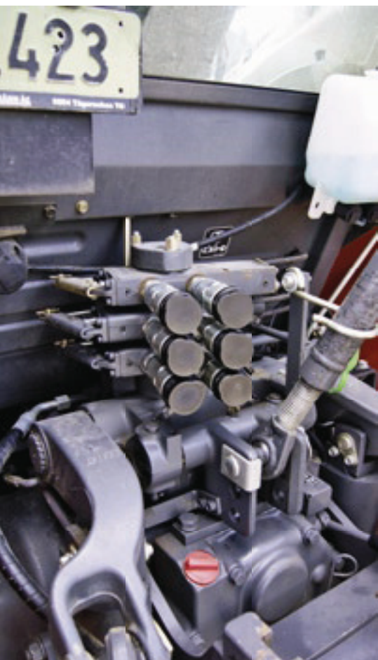
Praktisches Detail: Abgewinkelte Anschlüsse erleichtern das Kuppeln der Hydraulikschläuche.
